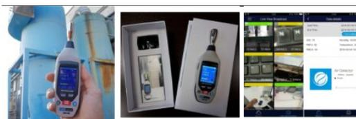
La serie di strumenti ARW-90-92- 95- 96 offre una valida soluzione per la misurazione di parametri quali Luminosità, velocità dell'aria, rumore e concentrazione di polveri sottili "Particolato". La struttura robusta, moderna e di dimensioni contenute è stata progettata per utilizzi professionali e si presta particolarmente ad un utilizzo frequente e veloce.
