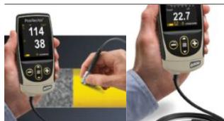
Il PosiTector6000 è uno spessimetro per rivestimenti robusto e completamente elettronico, basato sul principio dell'induzione magnetica e delle correnti parassite, può misurare velocemente ed in maniera accurata lo spessore dei rivestimenti sia su metalli ferrosi che su metalli non ferrosi. **Semplice:**
